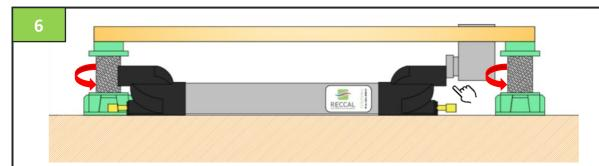
Stellen Sie "TurboSiphon" unter die Duschwanne und stellen Sie die Höhe der Füße so ein, dass "TurboSiphon" mit dem Abfluss verbunden werden kann.
