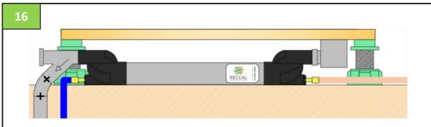
Die Installation von TurboSiphon ist abgeschlossen, die Duschwanne kann installiert werden.
